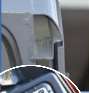
Montanti cabina a sezione pentagonale (resistenza)
