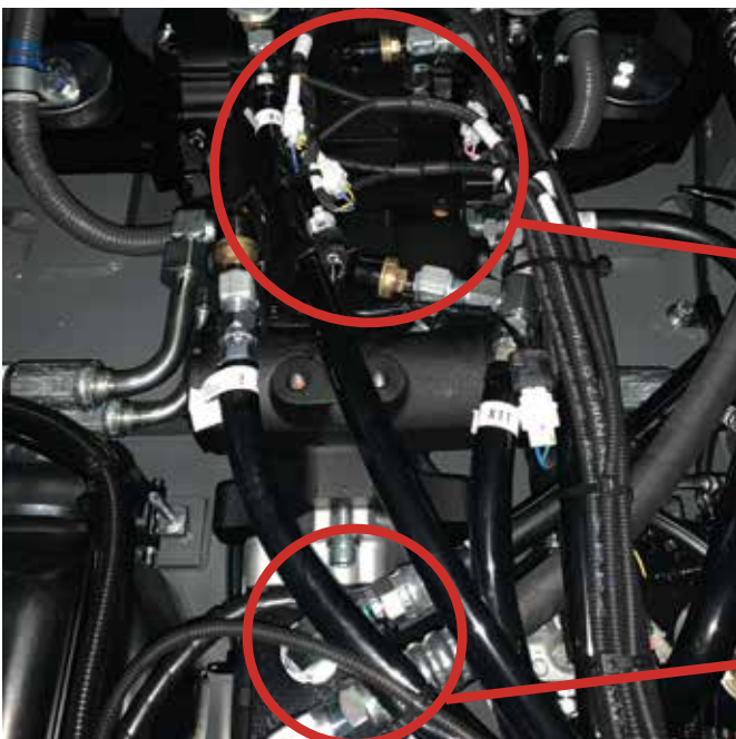
Main Pump Daikin - Sauer - Danfoss a portata variabile da 24,6 cm 3
