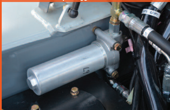
Filtro dei pilotaggi ben accessibile
