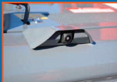
TELECAMERA POSTERIORE La retrocamera è montata in posizione protetta e le immagini si visualizzano all'interno del monitor lcd a colori. Si può impostare l'azionamento automatico in fase di retromarcia così come l'inquadratura fissa.
