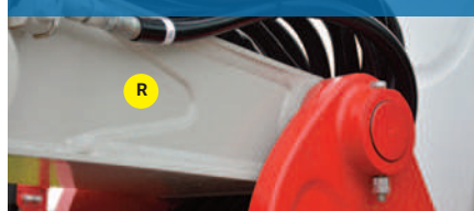
Rinforzi alla base del braccio
