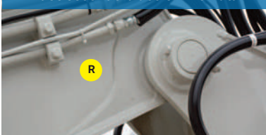
Base secondo braccio rinforzata
