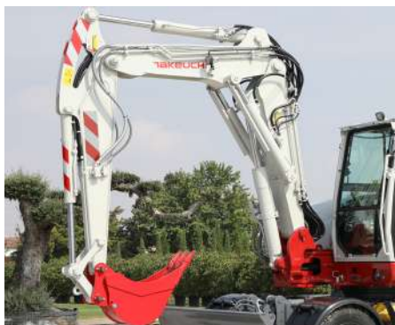
CATARIFRANGENTI BICOLORE SUL BRACCIO
