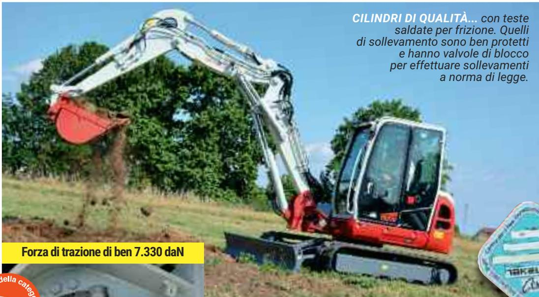
**CILINDRI DI QUALITÀ...** con teste saldate per frizione. Quelli di sollevamento sono ben protetti e hanno valvole di blocco per effettuare sollevamenti a norma di legge.
