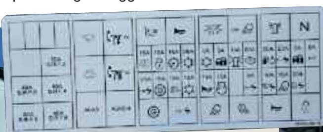
**IMPIANTO ELETTRICO CURATO** La batteria da 110 Ah e il quadro fusibili con legenda a icone sono nella parte anteriore della torretta, ben protetti. La macchina ha lo stacca batteria automatico.
