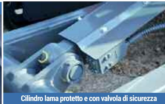
Cilindro lama protetto e con valvola di sicurezza
