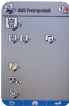
**DUE AUX REGOLABILI** Le linee Aux proporzionali sono due. La Aux 2 può essere utilizzata per funzioni idrauliche Aux 4 per gestire attacchi rapidi o rotazioni.
