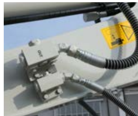
Rubinetti all'uscita dell'impianto ausiliario per evitare spillamenti e perdite di pressione in fase di installazione / disinstallazione delle attrezzature.
