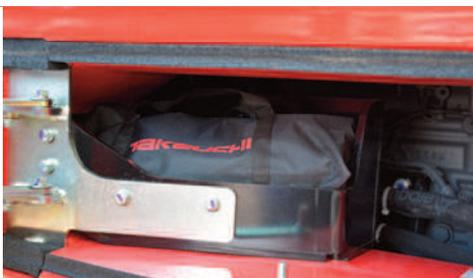
Zavorra posteriore con botola porta attrezzi che permette di accedere al filtro olio motore
