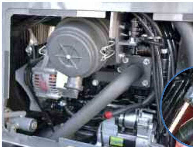
**SEMBRA UGUALE MA NON È** Il motore 100% meccanico (nessuna Ecu) ottiene emissioni in linea con gli standard Stage V (vista la potenza inferiore ai 19 kW), senza filtri di particolato allo scarico o iniezioni di urea. I progettisti hanno lavorato sull'efficienza della combustione ridisegnando le camere e dosando in moto più preciso sia l'immissione di carburante sia l'aspirazione.
