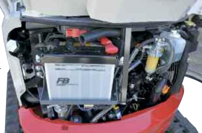
Il bocchettone è sotto chiave e con filtro asportabile. Per evitare di bagnare la macchina di gasolio c'è un indicatore sul serbatoio!
