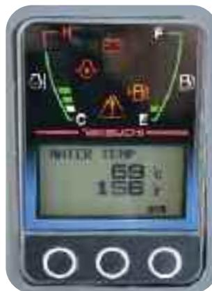
**TEMPERATURA MOTORE** Il refrigerante è monitorato con i led sulla parte sinistra del cruscotto e la temperatura si può visualizzare sull'LCD.
