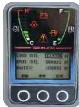
**MANUTENZIONE** La progressione delle ore operative è resettabile per tre parametri: olio motore, idraulico e refrigerante.
